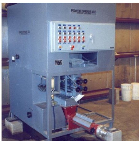
Mezclador de Slurry continuo y automático - 1980
