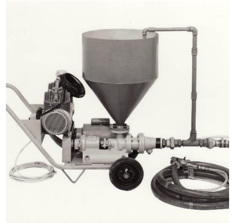
Primeras Bombas de lechada de cemento
