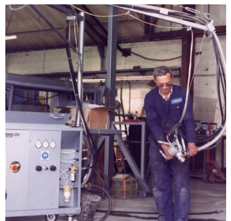
MKIX Máquina de pulverización GRC / GFRC con pistola de pulverización concéntrica
